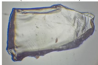
Figura 04: Microscopia óptica dos grãos da Areia 3 (aumento de 100 vezes).
