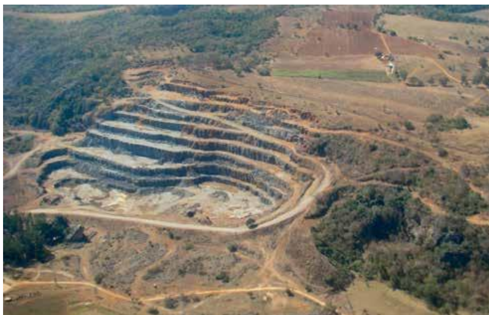
Figura 2. Lavra de mina de calcário a céu aberto na região de Confins (MG). Retirado do livro "Mina a céu aberto", publicado pela editora Oficina de Textos. Todos os direitos reservados.
