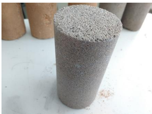
Figura 5. Corpo-de-prova sem adição de pó cerâmico.
