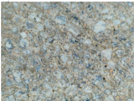
Figura 5. Corpo-de-prova sem adição de pó cerâmico.
