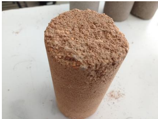
Figura 6. Corpo-de-prova com adição de pó cerâmico apresentando desgaste superficial no topo da amostra.
