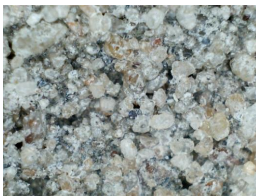
Figura 6. Corpo-de-prova com adição de pó cerâmico apresentando desgaste superficial no topo da amostra.
